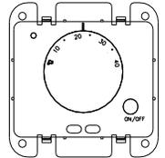
Снимите рамку с терморегулятора, **2В**
