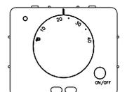
**4А** Установите заднюю часть термостата в монтажную коробку, закрепив её двумя болтами
