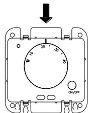
**3А** Используя две плоские отвертки, снимите центральную панель.
