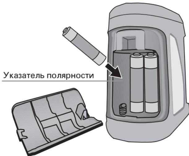
1. Снимите крышку батареи сзади устройства.
