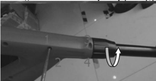
**Установка дополнительной рукоятки**
