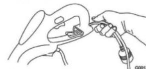
Крепление шнура удлинителя поможет Вам самопроизвольного отключения снегоборщика от сети при неожиданных рывках.
