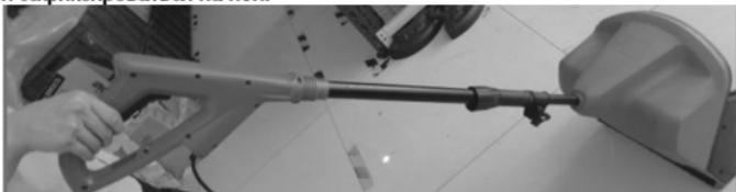
3. Установите 4 винта в отверстия на рукоятке, помеченные цифрами 1-4. Затяните винты. Затем надежно затяните пластиковую гайку-фиксатор, расположенную на штанге:
