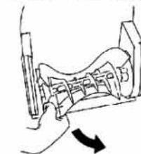
3. Установите новый шнек в корпус, совместив отверстие в шнеке и место крепления шнека на корпусе. Обратите внимание: отверстие в шнеке и место крепления на корпусе имеют сложную геометрическую форму. Поворачивайте шнек вокруг оси до тех пор, пока геометрия отверстия и крепления полностью не совпадут.
