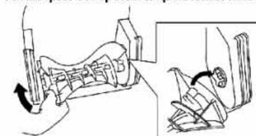
4. Установите и затяните болт на боковой поверхности корпуса:
