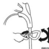
3. Затяните винт-ручку по часовой стрелке.
