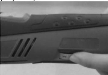
Чем больше цифра на регуляторе частоты колебаний (5), тем выше частота колебаний многофункционального инструмента.
