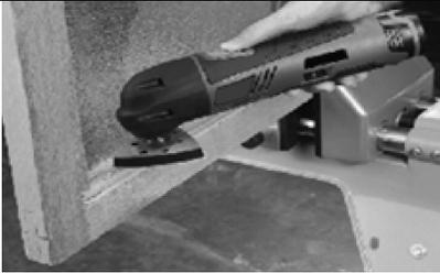
**ПРИМЕЧАНИЕ:** для достижения наилучших результатов шлифовальная платформа должна прилегать к заготовке всей поверхностью. Не наклоняйте шлифовальную платформу по отношению к рабочей поверхности и не используйте край шлифовальной бумаги, иначе шлифовальная платформа получит повреждения. Поврежденная шлифовальная платформа будет недостаточно прилегать к рабочей поверхности.
