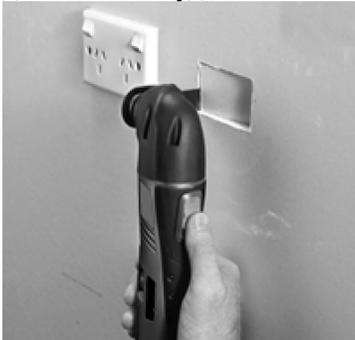
**ПРИМЕЧАНИЕ:** Многофункциональный инструмент может быть использован для изготовления отверстий в центре материала без использования дрели или лобзика. Используйте данную операцию только на мягких материалах, таких как древесина или гипсокартон. Также следует проверить наличие гвоздей или шурупов на заготовке перед резкой.
