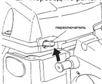
3. Нажмите одновременно рычаг газа и кнопку фиксации рычага газа, удерживая рычаг газа и кнопку фиксации, нажмите кнопку блокировки. Отпустите кнопку газа, при этом кнопка газа зафиксируется в стартовой позиции.
