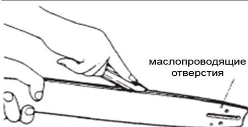
Смажьте маслом переднюю звездочку через масло-заливное отверстие, расположенное на передней части шины.
