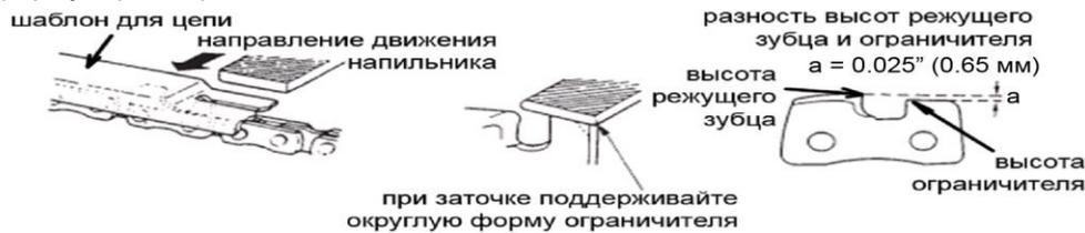
Убедитесь в правильности заточки заднего края ограничителя глубины резки. Поддерживайте округлую форму заднего края ограничителя для предотвращения эффекта отдачи или поломки цепи.
