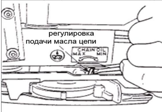
Не используйте пилу, если масляный бак пуст! Неработающая система смазки цепи ведет к быстрому выходу из строя всей пилы.
