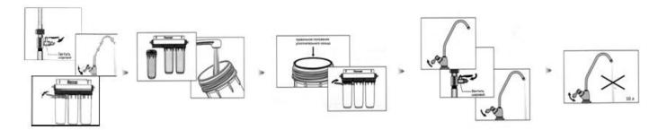
**Внимание!** Замену фильтролементов необходимо производить регулярно, не реже одного раза в год. В случае, если на вход водоочистителя поступает вода с большим содержанием механических загрязнений, то фильтролемент первой ступени необходимо менять при снижении расхода чистой воды меньше оптимального.
