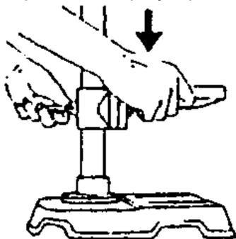
Регулировка угла наклона вертикального стола
