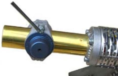
Т.н. колодочные насадки предназначены для стержневых аппаратов. Они идеальны для сварки в условиях ограниченного доступа. Диапазон стандартных диаметров колодочных насадок для раструбной сварки 16–63 мм. В качестве опции поставляется колодочная насадка Plate100 с плоскими рабочими поверхностями, она предназначена для стыковой сварки труб до Ø90мм в неответственных местах.
