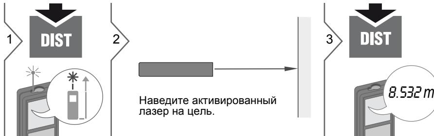
**i** Целевые поверхности: Ошибки при измерениях могут возникнуть в случае выполнения измерений до таких поверхностей, как бесцветные жидкости, стекло, стирофом, матовые полупроницаемые поверхности или при наведении на очень блестящие поверхности. При наведении на темные поверхности время измерения увеличивается.
