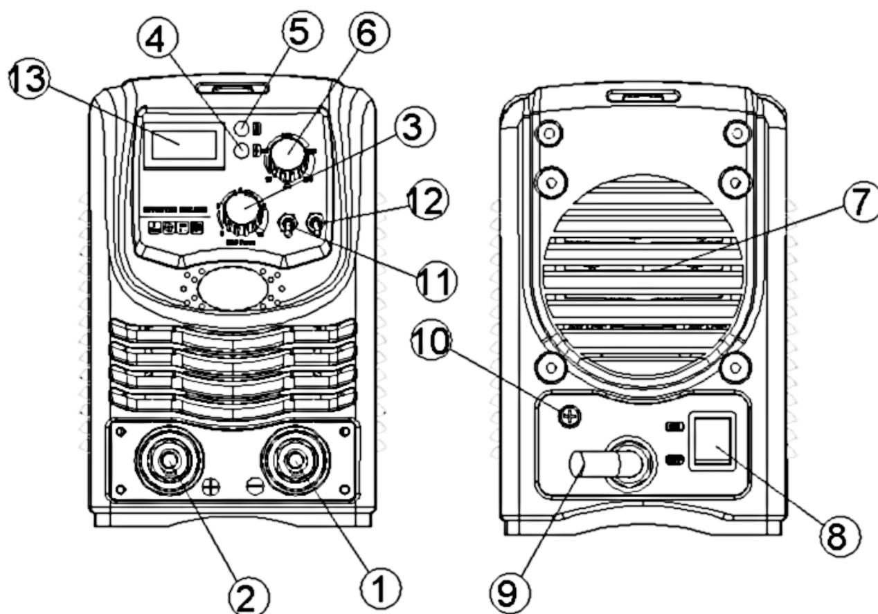
1. Клемма «-», для подключения зажима массы.
