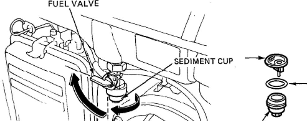
Каждые 100 часов работы чистите топливный фильтр отстойник.
