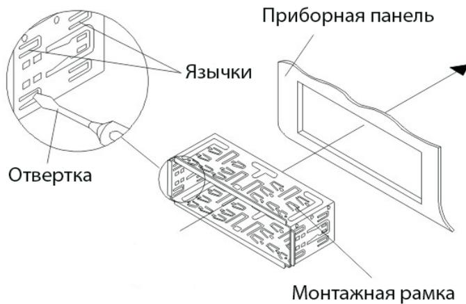
3) Подсоедините к проигрывателю разъемы питания и динамиков, разъем антенны. Убедитесь, что провода нигде не пережаты. Аккуратно вставьте проигрыватель в монтажную раму до щелчка фиксаторов, следя при этом за положением подключенных проводов, чтобы случайно не повредить их.
