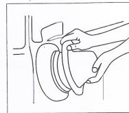
6. При работе в плохо доступных местах (например, зеркала заднего вида, бамперы, дверные ручки и пр.), снять полировальный чехол с полировальника и выполнить полировку вручную.
