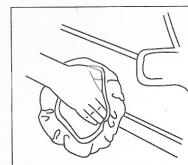
7. Заменить полировальный чехол с коротким ворсом на чехол с более длинным ворсом и натянуть его на полировальную подушку. Убедитесь в его чистоте. Удалить слой полироли в том же порядке, в каком он наносился.
