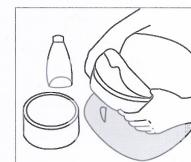
2. Равномерно нанести полироль по полировальному. Не наносить полироль непосредственно на полируемую поверхность.
