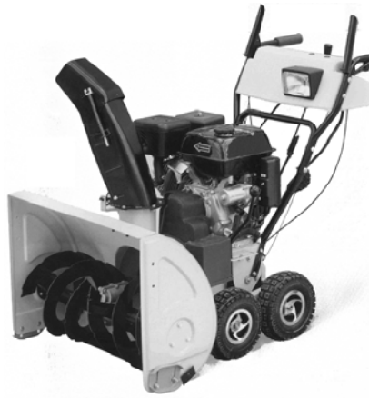
Рис. 1. Механизированные снегоуборщики с двигателем внутреннего сгорания а- MST1100E; б- MST1300E.
