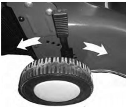
Регулировка высоты среза травы осуществляется поворотом ручки центрального регулирования. Ручка имеет пять фиксированных положений соответствующих разной высоте среза (минимальная высота среза соответствует крайнему левому положению).
