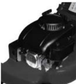
**Внимание!** Двигатель поставляется без масла. Перед использованием залейте в отверстие для заливки масла 0,6 литра машинного масла.
