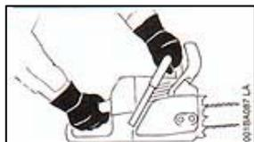
При работе мотопилу удерживать всегда обеими руками: правая рука всегда на задней ручке – это действительно также для левши. Для надежного ведения мотопилы трубчатую рукоятку и ручку схватить плотно большим пальцем. Во время работы необходимо занять надежное и устойчивое положение. Мотопилу при полной подаче топлива вставить в рез и насадить прочно зубчатый упор – и лишь после этого можно начать пиление.
