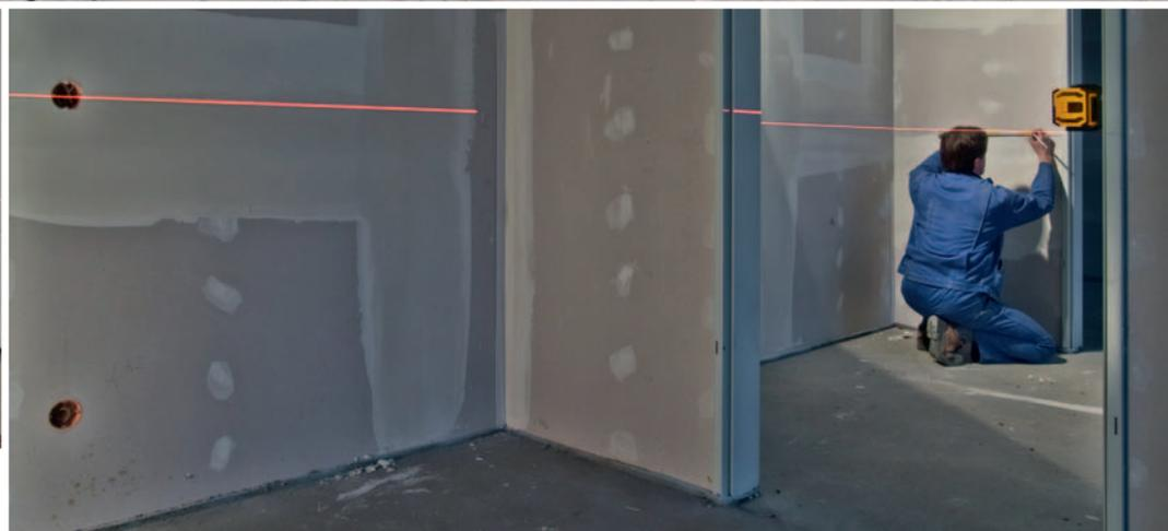
▲ Быстрое выполнение работ за счет удобного позиционирования: на полу, на штативе, с помощью редкоземельных магнитов и V-образной канавки на стальных балках и планках.
