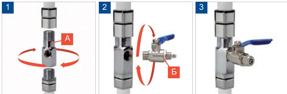
Верните в адаптер шаровой кран (Б) подачи воды (рис. 2)
