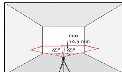
Das Gerät in 5 m Entfernung von der Wand aufstellen, einschalten und von links nach rechts oder von rechts nach links bewegen. Dabei die Höhendifferenz der Strahlenden auf der rechten und auf der linken Seite vergleichen. Beträgt die Differenz nicht mehr als 4.5 mm, liegt das Gerät innerhalb seiner Genauigkeitstoleranz.
