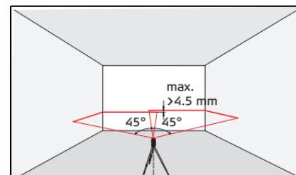
Colocar el instrumento a 5m de distancia del muro, encenderlo, moverlo de izquierda a derecha o viceversa y comparar los extremos del rayo de lado derecho e izquierdo para observar la diferencia en altura. Si la diferencia es menor de 4.5 mm, el instrumento estará dentro del intervalo de tolerancia.
