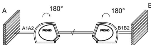
Включите на лазерном нивелире функцию определения горизонтальности в режиме "открыто". Установите прибор на штатив посередине между двумя стенами (A+B).
