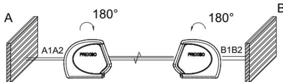
Accendere il laser a linee trasversali per il livellamento orizzontale in modalità non bloccata. Installare lo strumento su un treppiede a metà distanza fra due pareti (A+B).
