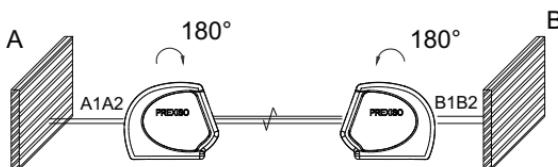
Encender el láser para nivelar horizontalmente en modo unlocked. Colocar el instrumento sobre un trípode a la mitad de ambos muros (A+B).
