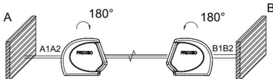
在开锁模式下，将激光标线仪开启至水平调平。将仪器固定在两堵墙 (A+B) 中间的三脚架上。
