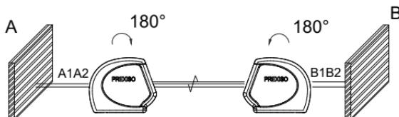
Allumez le laser à lignes croisées pour un calage à l'horizontale en mode déverrouillé. Installez l'instrument sur un trépied à mi-chemin des murs (A+B).
