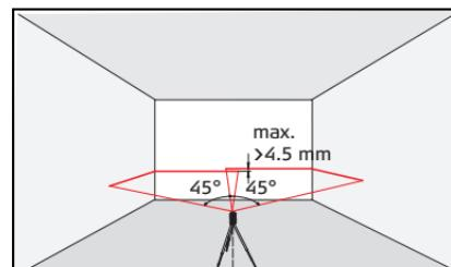
将仪器放置在离墙 5 米远的地方，打开仪器并将其从左至右或从右至左移动，然后比较右侧与左侧激光端的高度差。如果高度差未超过 4.5 毫米，则表示您的仪器在误差范围内。
