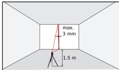
Как точку отсчета используйте отвес и установите его как можно ближе к стене высотой приблизительно 3 м.
