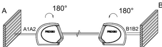
Kreuzliniendlaser einschalten und im entriegelten Modus die horizontale Nivellierung aktivieren. Das Gerät auf einem Stativ mittig zwischen den beiden Wänden (A+B) aufstellen.
