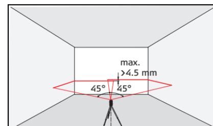
Разместите прибор на расстоянии 5 м от стены, включите его, передвиньте его слева направо или сравните левый и правый концы луча для определения перепада высот. Если разница не более 4,5 мм, значит точность прибора в пределах допустимого.
