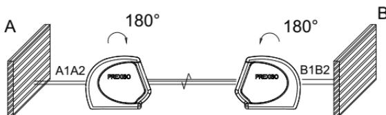
Ligar o laser para nivelamento horizontal em modo desbloqueado. Colocar o instrumento sobre um tripé num ponto equidistante das duas paredes (A+B).
