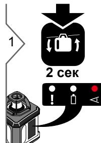
Наклонить ось X плоскости лазера с помощью пульта.
