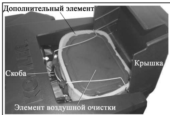
Рис. 11. Система очистки воздуха.
