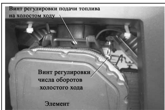
Рис. 16. Расположение элементов для настройки карбюратора в отсеке (Скоба снята для наглядности).
