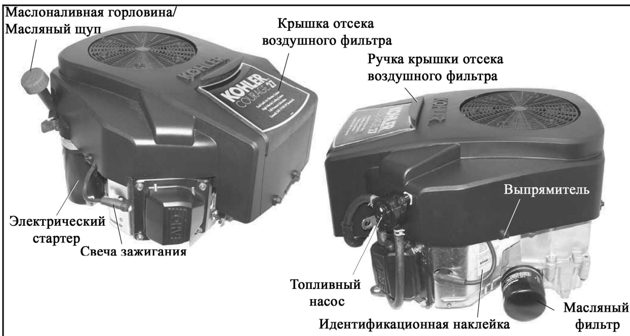
Рис. 1. Стандартный двигатель с вертикальным расположением коленчатого вала серии Courage.
