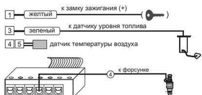
Дополнительные возможности МК при подключении опциональных цепей:
