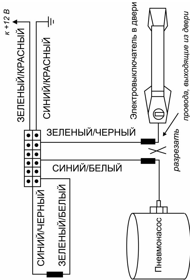
**Схема 5. Однолинейный тип цепи дверных замков с отрицательной полярностью (некоторые автомобили марки Nissan, Mazda и др.)**
