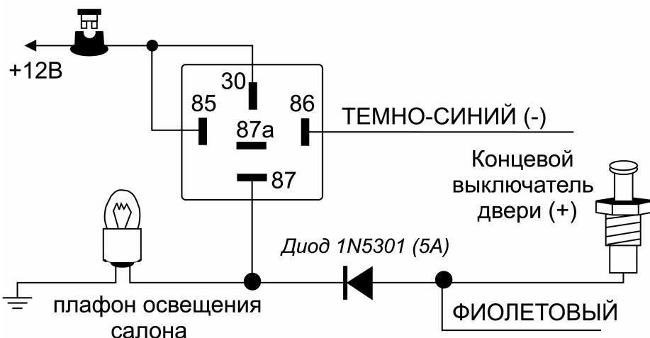
**Подсоединение:** Подсоедините ТЕМНО-СИНИЙ провод к контакту № 86 дополнительного 30A реле и подсоедините контакт № 85 реле к +12В через предохранитель. Подсоедините остальные контакты реле в соответствии с полярностью цепи внутрисалонного освещения автомобиля как показано на схемах.
