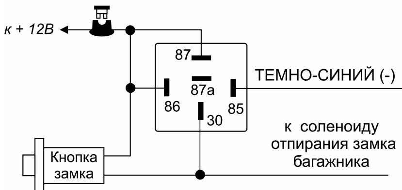
**Подсоединение:** Подсоедините ТЕМНО-СИНИЙ провод к контакту № 85 дополнительного 30A реле, подсоедините контакт № 86 реле к +12В. Подсоедините остальные контакты реле как показано на схеме или в соответствии с выбранной функцией канала 2 системы.
