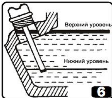
Откройте крышку маслозаливной горловины. Если уровень масла низкий, долейте масло рекомендованного вида и вязкости до нижнего края маслозаливной горловины (**Рис.6**). Закрутите крышку маслозаливной горловины.
