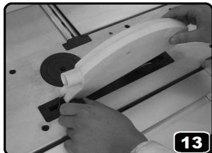
овернуть / затянуть рукоятку по ходу движения часовой стрелки.
