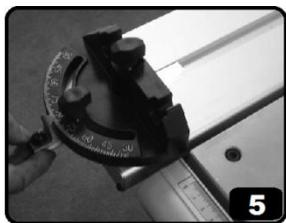
Установите програддуированную направляющую рабочего стола (Рис.5).
