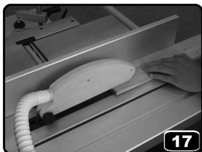
Хорошо прижимайте заготовку к упорным частям (Рис.17). При косом резе воспользуйтесь угловой проградуированной направляющей (Рис.18).
