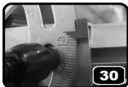
Вертикальную регулировку направляющей можно осуществлять в соответствии с проградуированной шкалой-транспортиром (Рис.30). После регулировки зафиксируйте направляющую.
