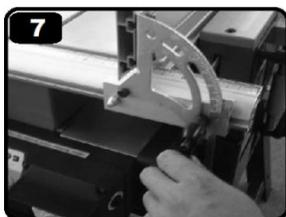
Прикрепите регулируемую боковую направляющую (Рис.6, Рис.7). Затем затяните ручки и зафиксируйте ее в необходимом положении.
