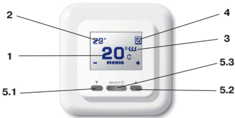
**Рис. 2** Главная индикация в основном режиме работы
