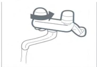
• Следует стараться максимально открывать кран горячей воды, иначе розжиг может не произойти или пламя может погаснуть при смешивании горячей и холодной воды.
