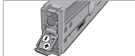
Откиньте крышку батарейного отсека **20** и вставьте батарейки. При этом следите за соблюдением полярности в соответствии с изображением на внутренней стороне крышки батарейного отсека.
