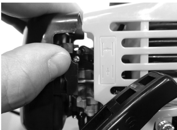
Рис. 4 Рычаг управления воздушной заслонкой в положении «ЗАКРЫТО»
