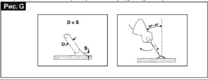
Заканчивая сварочный шов, отведите электрод немного назад, чтобы заполнился сварочный кратер, а затем резко поднимите его до исчезновения дуги.
