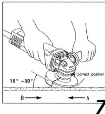
**ПРИМЕЧАНИЕ.** Подготовьтесь к сильному искрению, которое появляется в момент касания диском металла. Во время шлифования постоянно держите правильный угол между шлифовальным диском и рабочей поверхностью. Благодаря этому достигается оптимальный результат и предупреждается перегрузка машины.
