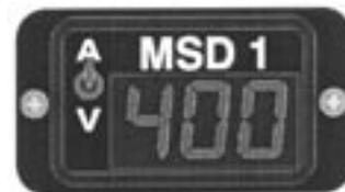
Для монтажа прибора MSD1 снимите заглушку с передней панели установки. Подключите штеккер ленточного кабеля, расположенный под заглушкой, к соответствующий разъем MSD1. Переключателем прибора выбирается показание либо напряжения либо тока. На холостом ходу показывается значение напряжения, потому что сварочного тока нет.
