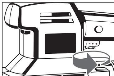
**Выключатель "On-Off" ("Вкл./Выкл.")**
