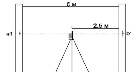
Повторите измерения на расстоянии примерно 0.6 м от одной стены и на расстоянии примерно 4.4 м от другой. Отклонение между первым замером (с одинаковыми расстояниями до точек замера), и вторым замером (с расстоянием 0.6м и 4.4м) не должно превышать 3мм.
