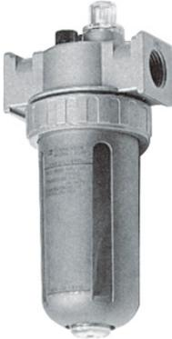
Для обогащения воздуха маслом самый лучший способ – это установка в пневмолинию смазывающего устройства – лубризатора, который устанавливаются после фильтра, и он будет производить смазку автоматически. Его следует регулярно проверять и заполнять маслом, предназначенным для пневмоинструментов.
