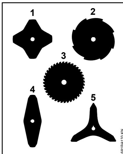
Режущие инструменты с 2, 3 или 4 крыльями (1, 4, 5) могут указывать в любом направлении – данные режущие инструменты переворачивать регулярно во избежание одностороннего износа.
