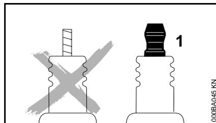
**⚠** У свечи зажигания с отдельной подсоединительной гайкой (1) обязательно подсоединительную гайку прикрутить на резьбу та **плотно** затянуть – из-за образования искры **опасность пожара!**
