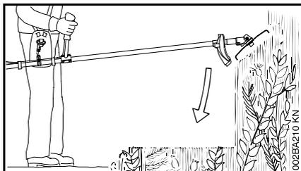
Измельчающий нож “погружайте” в частый кустарник и мелкую заросль, – разрезаемый материал измельчается, – при этом, режущий инструмент не держите выше бедра.
