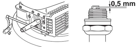
**ВНИМАНИЕ!** Използвайте винаги запалителните свещи от препоръчания вид! Използуването на погрешен тип свещи може да предизвика сериозни повреди на буталото/цилиндъра.
