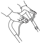
Запрещается на продолжительное время закреплять ручку тормоза при работающей машине.
