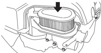
Καθαρίστε το φίλτρο κτυπώντας το φίλτρο σε μια επίπεδη επιφάνεια. Μην χρησιμοποιείτε ποτέ διαλυτικό με πετρέλαιο, για παράδειγμα, κηροζίνη ή συμπιεσμένο αέρα για τον καθαρισμό του φίλτρου.
