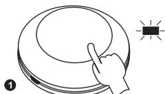
1 Нажать кнопку в RTI-01и придержать около 2 секунды, после отпустить кнопку. Зажжется (постоянный сигнал) красный диод LED.
