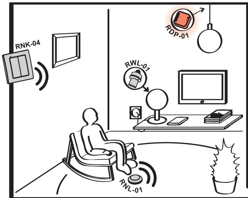
Встраиваемый радиодиммер RDP-01 работающий в качестве приемника четырехканального радиопередатчика RNK-04 (управление вкл/выкл и освещение/ затемнение источников света). Указанные передатчики могут также управлять работой радиовыключателя освещения RWL-01.
