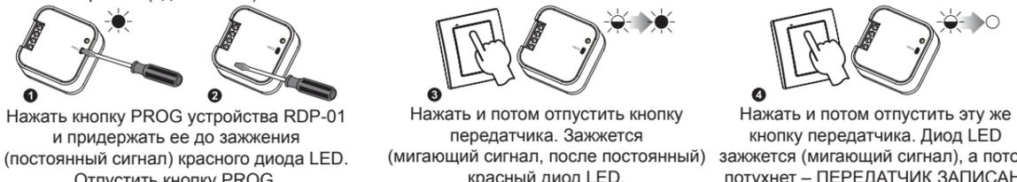
**ВНИМАНИЕ:** Каждый передатчик может работать с RDP-01 в другом режиме, в зависимости от способа введения его в устройство. В одном цикле программирования можно записать в устройстве один передатчик. Состояние полной памяти передатчиков сигнализируется миганием красного диода LED в ходе проб программирования очередных передатчиков.
