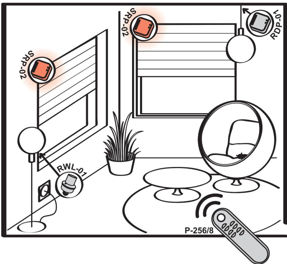
Система управления рольставнями, реализованная при помощи контроллеров рольставней SRP-02. Один контроллер может использоваться только для одной рольставни. Каждый из контроллеров запускается дистанционным пультом P-256/8. Пульт управления может также управлять работой встраиваемого радиодиммера RDP-01 (управление вкл/выкл и освещение/ затемнение источника света) а также радиовыключателя освещения RWL-01.
