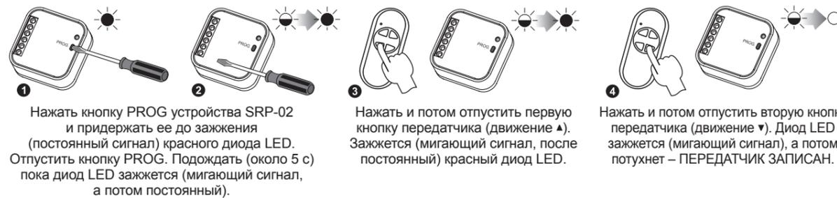
1 Нажать кнопку PROG устройства SRP-02 и придержать ее до загорания (постоянный сигнал) красного диода LED. Отпустить кнопку PROG. Подождать (около 5 с) пока диод LED загорится (мигающий сигнал, а потом постоянный).
