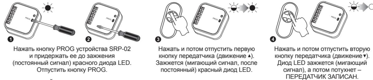
1 Нажать кнопку PROG устройства SRP-02 и придержать ее до загорания (постоянный сигнал) красного диода LED. Отпустить кнопку PROG.
