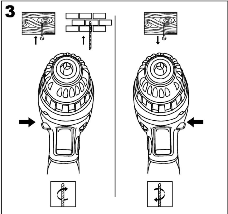
При помощи переключателя направления вращения можно установить направление вращения патрона по часовой или против часовой стрелки. Эта функция позволяет использовать данный инструмент в качестве шуруповерта.
