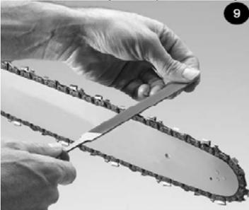
**ВНИМАНИЕ!** Во избежание перегрузки двигателя и повреждения цепи, устанавливайте минимальный размер снимаемого материала с зубьев и не затачивайте слишком долго один зуб.
