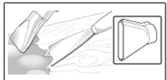
**В. Удаление лакокрасочных покрытий с оконных рам.****ВНИМАНИЕ! Опасность разрушения стекла!**
