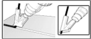
Место сварного шва нагреть до перехода материала в тестообразное состояние. Подвести сварочную проволоку и заполнить образующимся из нее расплавленным материалом зазор таким образом, чтобы образовался равномерный наплыв. Учтите, что диапазон температуры между тестообразным и жидким состоянием синтетического материала небольшой.
