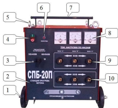
Рис. 1. Общий вид и устройство трансформатора.
