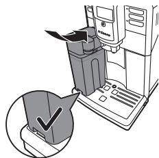
4 Слегка наклоните сосуд для молока и вставьте его в направляющие для машины. Затем прижмите нижнюю часть сосуда по направлению к машине, чтобы зафиксировать его на поддоне.
