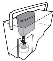
**17** Вставьте фильтр AquaClean в вертикальном положении в соответствующий разъем. Нажмите на фильтр AquaClean, чтобы он опустился вниз до упора. Для обеспечения оптимальной работы убедитесь, что фильтр плотно зафиксирован, а уплотнительный слой находится в правильном положении.
