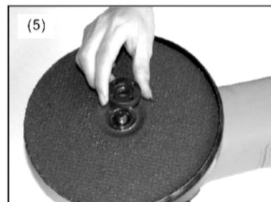
обратите внимание на то, какой стороной его надевать, это зависит от типа применяемого диска. Шлифовальный диск необходимо зажимать той стороной наружного фланца, на которой имеется кольцевой выступ, входящий в внутреннее отверстие диска. Отрезной диск необходимо зажимать плоской стороной наружного фланца.
