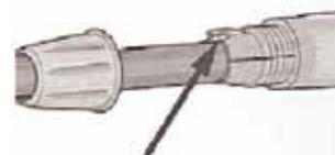
4. Навинтите и затяните большую пластиковую гайку.
