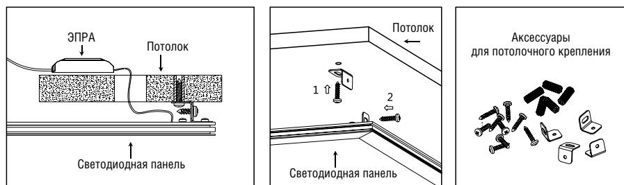
– Рисунок 4. Монтаж при помощи комплекта LP-KPP-K –
