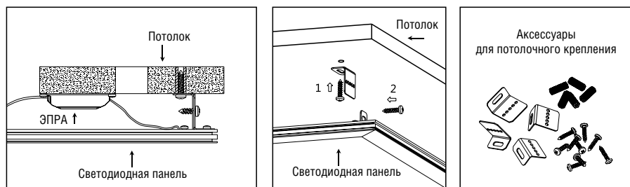
– Рисунок 5. Монтаж при помощи комплекта LP-KPP-D –
