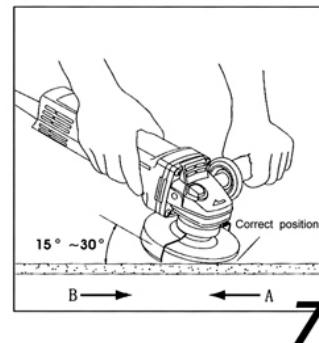
**ПРИМЕЧАНИЕ.** Подготовьтесь к сильному искрению, которое появляется в момент касания диском металла. Во время шлифования постоянно держите правильный угол между шлифовальным диском и рабочей поверхностью. Благодаря этому достигается оптимальный результат и предупреждается перегрузка машины.
