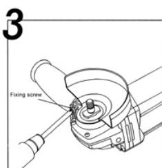
Установите защитный кожух так, чтобы исключался выброс искр в направление оператора.
