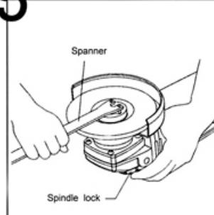
**ВНИМАНИЕ!** Кнопка стопорного вала используется только для установки и демонтажа диска. Не используйте ее в качестве аварийной кнопки, когда работает электроинструмент. В противном случае это может привести к поломке инструмента или нанесению телесных повреждений.
