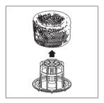
5 Оставьте увлажняющий фильтр в водопроводной воде на один час.
